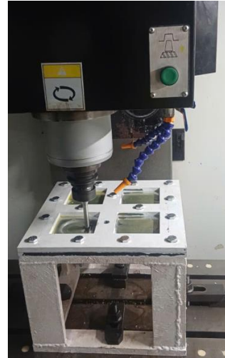
Hình 15. Hình ảnh gia công trên đồ gá nhiều vị trí gia công
