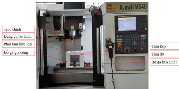
Hình 7. Phương án gá đặt gia công trên máy X.mill M640
