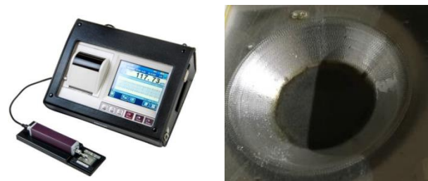
Hình 16. Máy đo độ nhám và sản phẩm gia công
